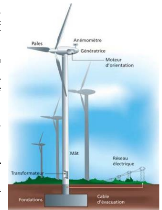
Figure 8 : Représentation schématique d'une éolienne (Source : EDF)
