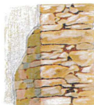
mur ancien souvent maçonné à la terre, enduits fins à la chaux (intérieur et extérieur)
