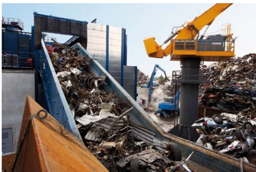
Chargement des VHU sur le convoyeur d'alimentation du broyeur Menut
