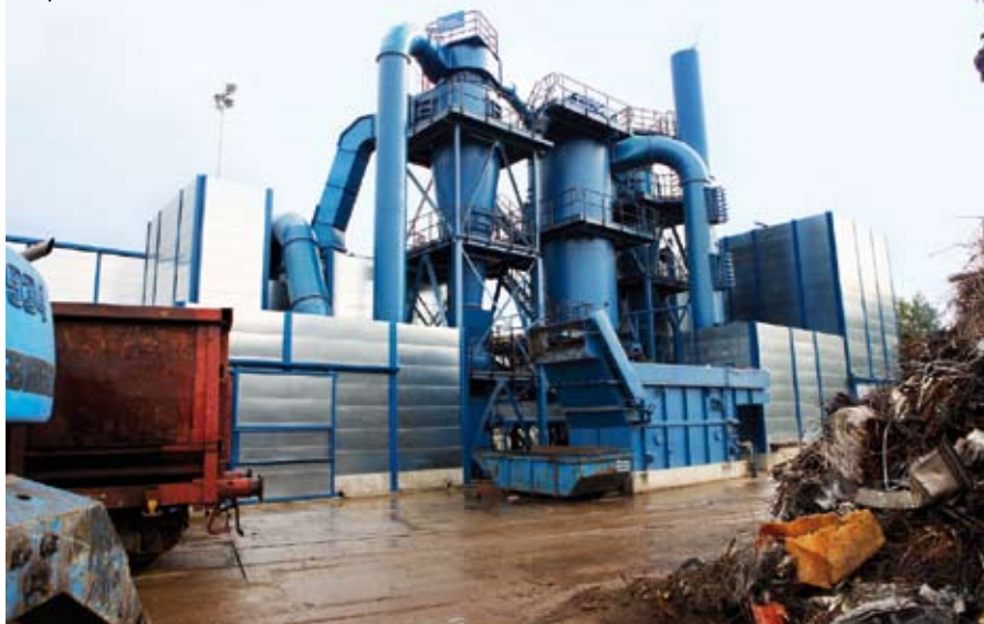
Broyeur à ferraille 2000 CV Menut - Mesto Lindemann
