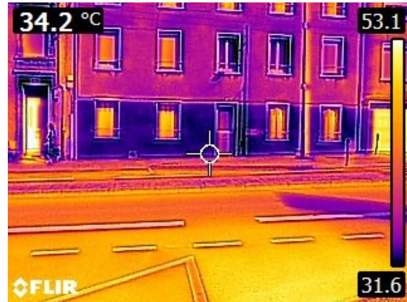
1er septembre 2022 à 17h00, Avenue Marcel Lemoine à Châteauroux. Variation des températures en fonction des matériaux et de la couleur (albédo), et pouvoir chauffant des sols imperméables goudronnés
