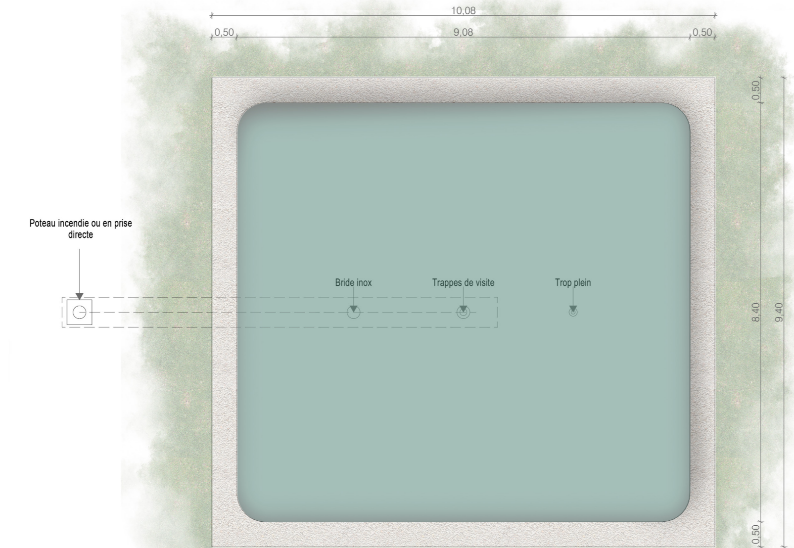
Citerne souple de 60m3 Dimensions : Longueur 9.08m, largeur 8.4m, hauteur 1.5m
