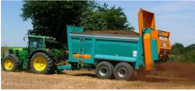
Photo : épandeur équipé d'une table d'épandage
