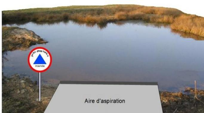
Sous réserve d'un débit ou d'une contenance suffisants et d'une profondeur permettant la mise en aspiration, ils conviennent parfaitement aux gros besoins en eau notamment pour les industries et les exploitations agricoles. Les berges doivent cependant être aménagées afin de permettre l'approche et le stationnement d'un ou plusieurs engins.
