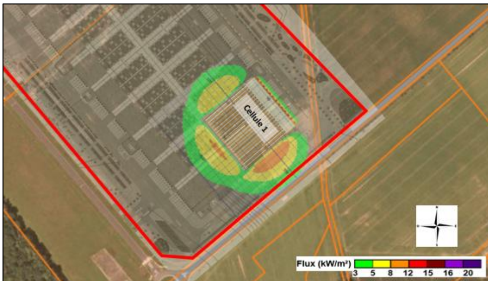
Cartographie des AM1 – Incendie de la cellule 1
